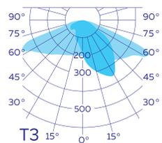
Линза с широким равномерным свечением. Используется для дорожного и уличного освещения. Шире, чем Т2
