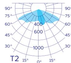
Линза с широким равномерным свечением. Используется для дорожного и уличного освещения.
