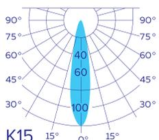
Концентрированная КСС, даёт направленный свет с ярким, узким световым пятном и применяется для архитектурной подсветки.
