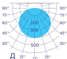
Косинусная (диффузная) кривая силы света. Она определяет угол распределения светового потока и составляет 120 градусов. Светильники с такой КСС дают равномерное освещение поверхности и используются для общего освещения любых объектов.
