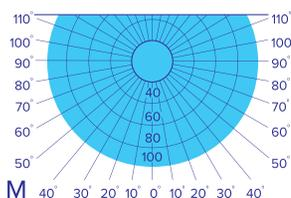
Угол рассеивания достигает 180°. Применяется при необходимости полного освещения зоны вокруг осветительного прибора. В основном применяется для освещения парковых дорожек и тропинок.
