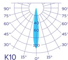
Концентрированная КСС, даёт направленный свет с ярким, узким световым пятном и применяется для архитектурной подсветки.
